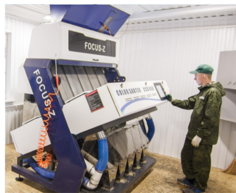
Очистка семян с использованием оптических сортировщиков позволяет добиваться 99,9%-ной чистоты продукта
