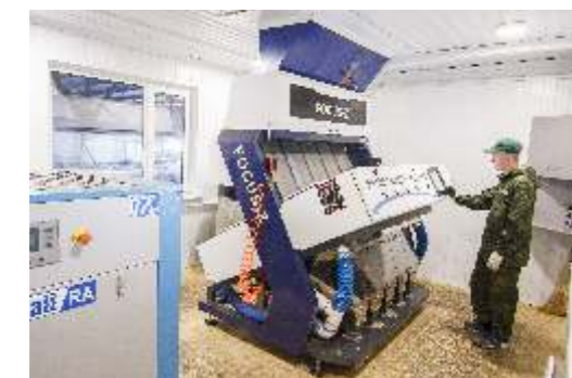
Линия очистки семян с использованием оптического сортировщика позволяет добиваться 99,9% чистоты продукта.
